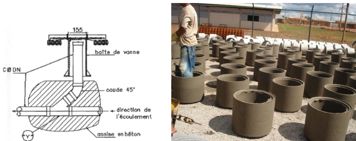
Figure 22 : A gauche : cheminée de visiter remplaçant (source : ONAS). A droite : fabrication en série de regards simplifiés à Brasilia (source : CAESB).
